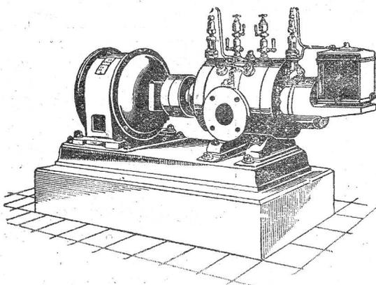
Direkte Kupplung mit Elektromotoren o. Riemenbetrieb.
