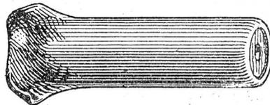
mit eingepresster, quer geschnittener Hartholzfüllung und vorn eingebogener Eisenhülse, in Längen von 30—80 mm und Dicken 9, 11, 14 mm, ist der solideste und zweckmässigste Dübel für alle Zwecke.
