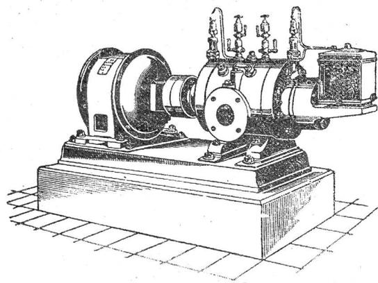
Direkte Kupplung mit Elektromotoren o. Riemenbetrieb.
