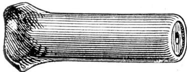
mit eingepresster, quer geschnittener Hartholzfüllung und vorn eingebogener Eisenhülse, in Längen von 30—80 mm und Dicken 9, 11, 14 mm, ist der solideste und zweckmäßigste Dübel für alle Zwecke.
