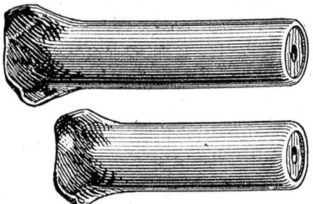
mit eingepresser, quer geschnittener Hartholzfüllung und vorn eingebogener Eisenhülse, in Längen von 30—80 mm und Dicken 9, 11, 14 mm, ist der solideste und zweckmässigste Dübel für alle Zwecke.
