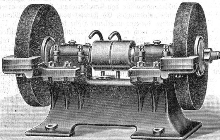
mit Ringschmier- oder Kugellagerung, in diversen Grössen,
