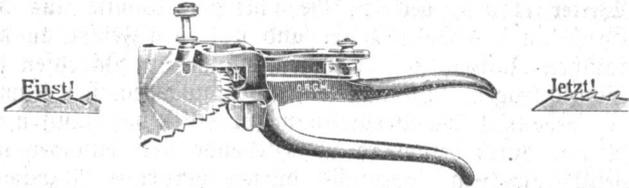
Der Blick ist von oben und wird jeder nächstfolgende Sägenzahn abwärts gedrückt, ohne daß mit der rechten Hand auf- oder abwärts eine Bewegung gemacht werden muß. Die Schränkweite des Sägenblattes ist an der Skalaschraube ersichtlich. Der Anschlag ist so zu stellen, daß der Sägenzahn von der Grundlinie aus glatt aufgedrückt wird, das macht den Zahn widerstandsfähig und verleiht den Sägen einen leichten Lauf und macht einen äußerst feinen sauberen Schnitt.
