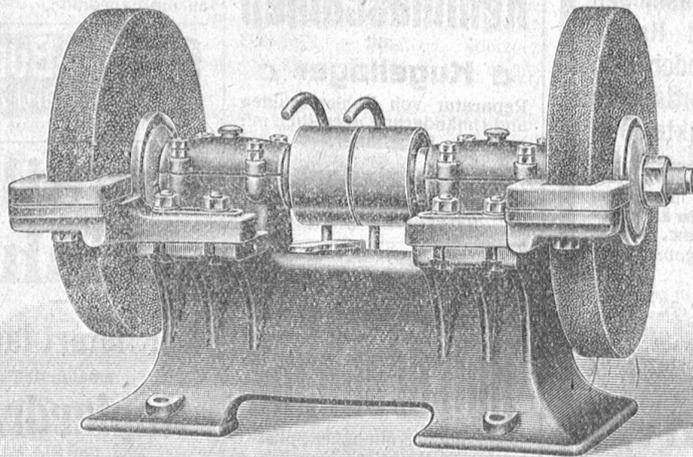
mit Ringschmier- oder Kugellagerung, in diversen Grössen,
