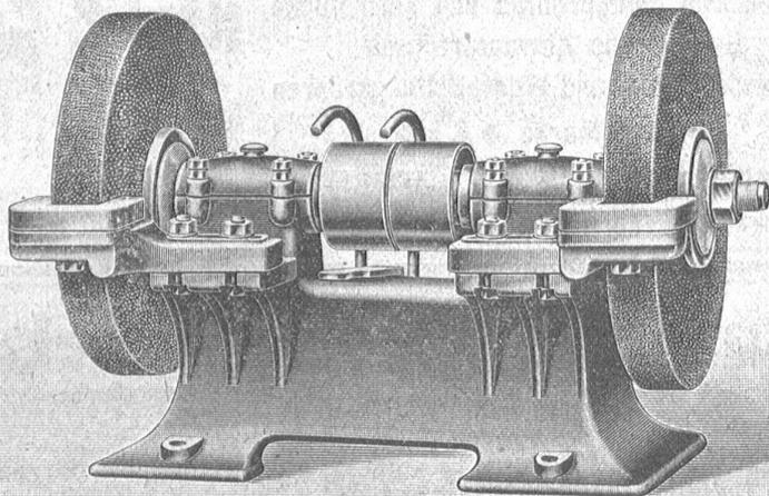
mit Ringschmier- oder Kugellagerung, in diversen Grössen,
