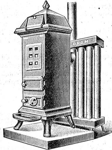
Die Konstruktion ist äußerst einfach. Der Anschluß kann von jedem Spengler oder Schlosser bewerkstelligt werden. Die aus dem Ofen abziehenden erhitzten Rauchschwaden und Gase, anstatt meist gleich nutzlos in den Kamin zu entweichen, gehen in den Heizkörper über, werden darin nach unten gestürzt, verteilen sich im
