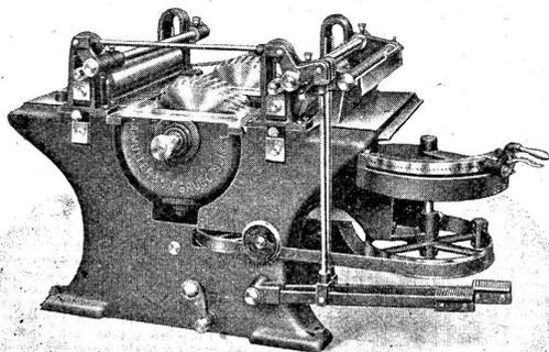
**Doppelte Besäum- und Lattenkreissäge**
