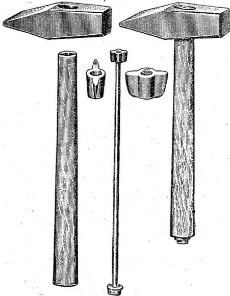
Abb. 7. Hammer mit durchbohrtem Stiel.
