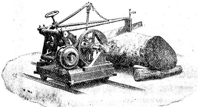
in den Handel gebracht worden, die obiges Reſultat ganz weſentlich zu Gunſten der Maſchinenarbeit einſtellt. Die neue Maſchine iſt auch eine Fuchſchwanz-Maſchinenſäge für Rundholz bis 1 m  $\phi$ , iſt aber durch ein neues Prinzip gelöſt, das eine weſentliche Krafter-
