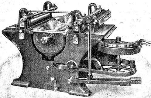
**Doppelte Besäum- und Lattenkreissäge**
