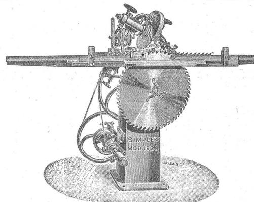
Obige 2 automatischen Sägeschärfmaschinen sind zum Schärfen von Gattersägen, Bandsägen und Fräsen konstruiert. Unerreichbar in Solidität und Leistungsfähigkeit. Modell 1920 ist noch extra zum Schärfen enger Zahnungen wie Bandsägen und kleiner Fräsen in Schreinerereien sowie für Eisenfräsen in mech. Werkstätten konstruiert. 868
