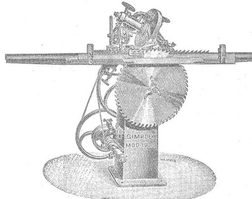
Obige 2 automatischen Sägenscharfmaschinen sind zum Schärfen von Gattersägen, Bandsägen und Fräsen konstruiert. Unerreichbar in Solidität und Leistungsfähigkeit. Modell 1920 ist noch extra zum Schärfen enger Zahnungen wie Bandsägen und kleiner Fräsen in Schreinerereien sowie für Eisenfräsen in mech. Werkstätten konstruiert.
