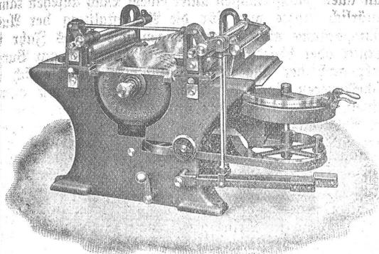
**Doppelte Besäum- und Lattenkreissäge**
