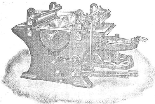
**Doppelte Besäum- und Lattenkreissäge**
