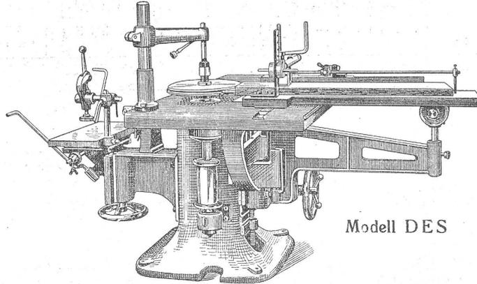
Mit Schwenkarm und Schiebetisch zum Ablängen und Zapfenschneiden
