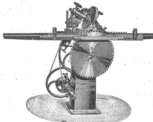
Obige 2 automatischen Sägenschrämmaschinen sind zum Schärfen von Gattersägen, Bandsägen und Fräsen konstruiert. Unerreichbar in Solidität und Leistungsfähigkeit. Modell 1920 ist noch extra zum Schärfen enger Zahnungen wie Bandsägen und kleiner Fräsen in Schreinereien sowie für Eisenfräsen in mech. Werkstätten konstruiert. 868
