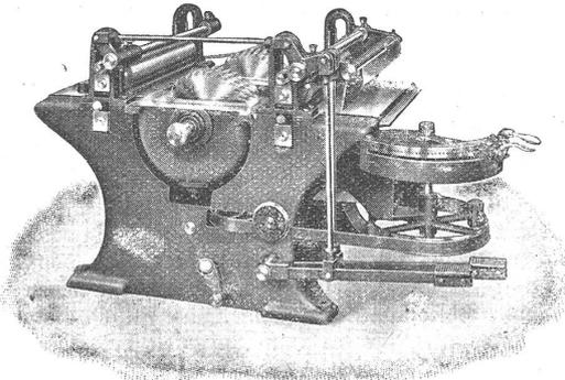
**Doppelte Besäum- und Lattenkreissäge**
