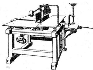
Komb. Abricht- u. Dickehobel-, Fräs- und Bohrmaschine
