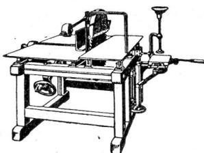
**Komb. Abricht- u. Dichehobel-, Fräs- und Bohrmaschine**
