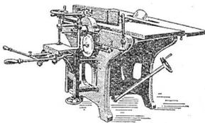
Abrichtbreite : 500 od. 600 mm
