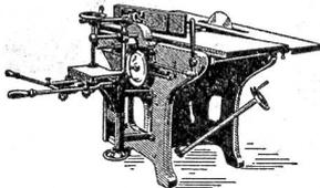
Abrichtbreite: 500 od. 600 mm
