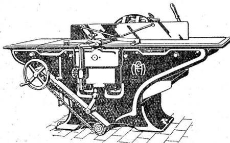
Kombinierte Abricht-, Kehl- und Dickenhobelmaschine 1 b
