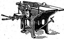
Abrichtbreite: 500 od. 600 mm
