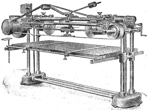
wird das zu schleifende Möbelstück, Türen, Rahmen, Gefäße etc. auf einem quer zum Bandlauf spielend leicht verschiebbaren Tisch aufgelegt, wobei der Arbeiter die Schleifleistung stets verfolgen kann. Das Aufdrücken des Schleifbandes kann so feinfühlig erfolgen, daß bei etwiger Übung selbst das dünnste Fournier ohne Gefahr des Durchputzens spiegelglatt geschliffen werden kann.
