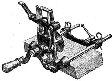
Handfräsapparat zum Einfräsen der Nuten für Fischbänder in Fenster, Türen, Rahmen etc. erledigt diese heikle Arbeit außerordentlich rasch und spielend leicht. Ein neuer verstellbarer Nut- und Falzfräser wird ebenfalls im Betrieb vorgeführt.
