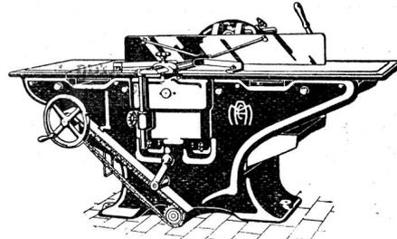
Kombinierte Abricht-, Kehl- und Dickenhobelmaschine 6b
