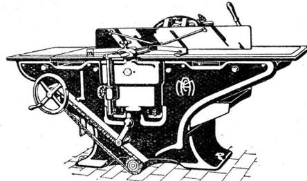
Kombinierte Abricht-, Kehl- und Dickenhobelmaschine 6b
