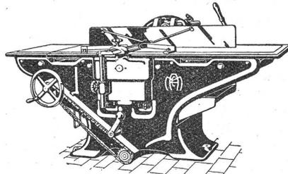
Kombinierte Abricht-, Kehl- und Dickenhobelmaschine 2 b
