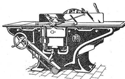
Kombinierte Abricht-, Kehl- und Dickenhobelmaschine 2 b
