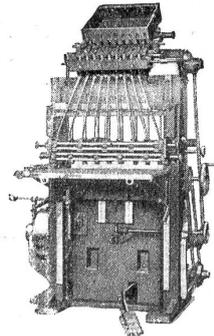
Kisten-Nagelmaschine „Triumpf“ Zickzacknagelung,
