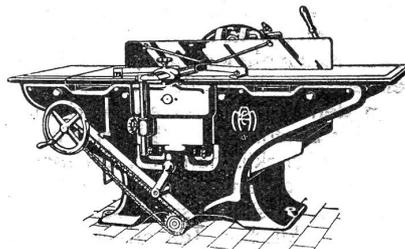
Kombinierte Abriht-, Kehl- und Dickenhobelmaschine 2 b
