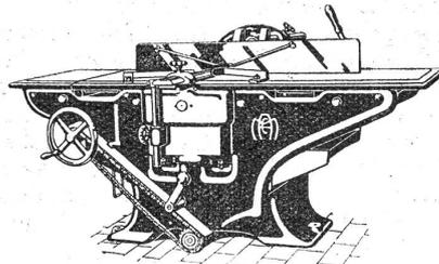
Kombinierte Abricht-, Kehl- und Dickenhobelmaschine 22b
