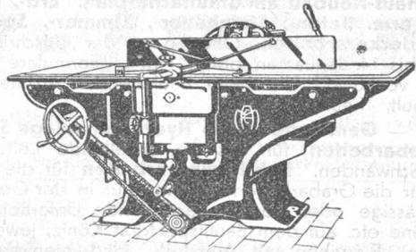
Kombinierte Abricht-, Kehl- und Dickenhobelmaschine 8b
