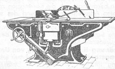
Kombinierte Abricht-, Kehl- und Dickenhobelmaschine 8b
