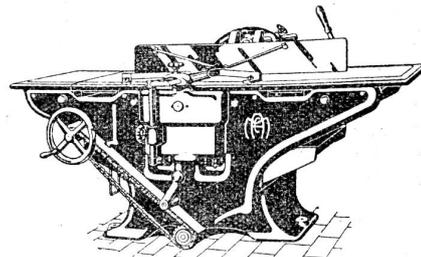
Kombinierte Abricht-, Kehl- und Dickenhobelmaschine 8b
