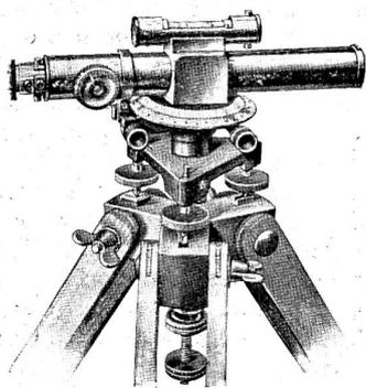
latte bis 200 m Entfernung. Wie aus der Abbildung ersichtlich, besitzt dieses Instrument außerdem noch einen Horizontalkreis je nach Wunsch in  $360^\circ$  oder  $400^\circ$  geteilt, sodaß jeder x-beliebige Winkel abgesteckt werden kann, ein Vorteil, der jedem Baufachmann sofort einleuchtet.
