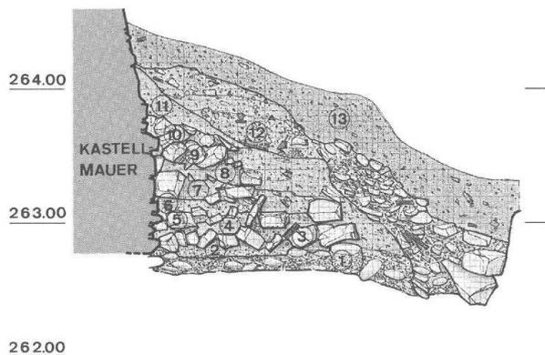
Abb. 19 Kaiseraugst – Rheinuferweg/Kirchgartenstützmauer (06). Profil durch das Kastellmauerfundament beim Zugang zum Baptisterium. M. 1:50. 1: anstehender Schotter, darauf feine Kalklinse. 3/5/7/9: Fundationsschichten aus Kalksteinbruchstücken. 2/4/6/8: Druckausgleichsschichten. 10: Schuttschicht. 11: nachrömische Planierung. 12: Bauschutt. 13: moderne Überdeckung. Aufnahme M. Schaub.
