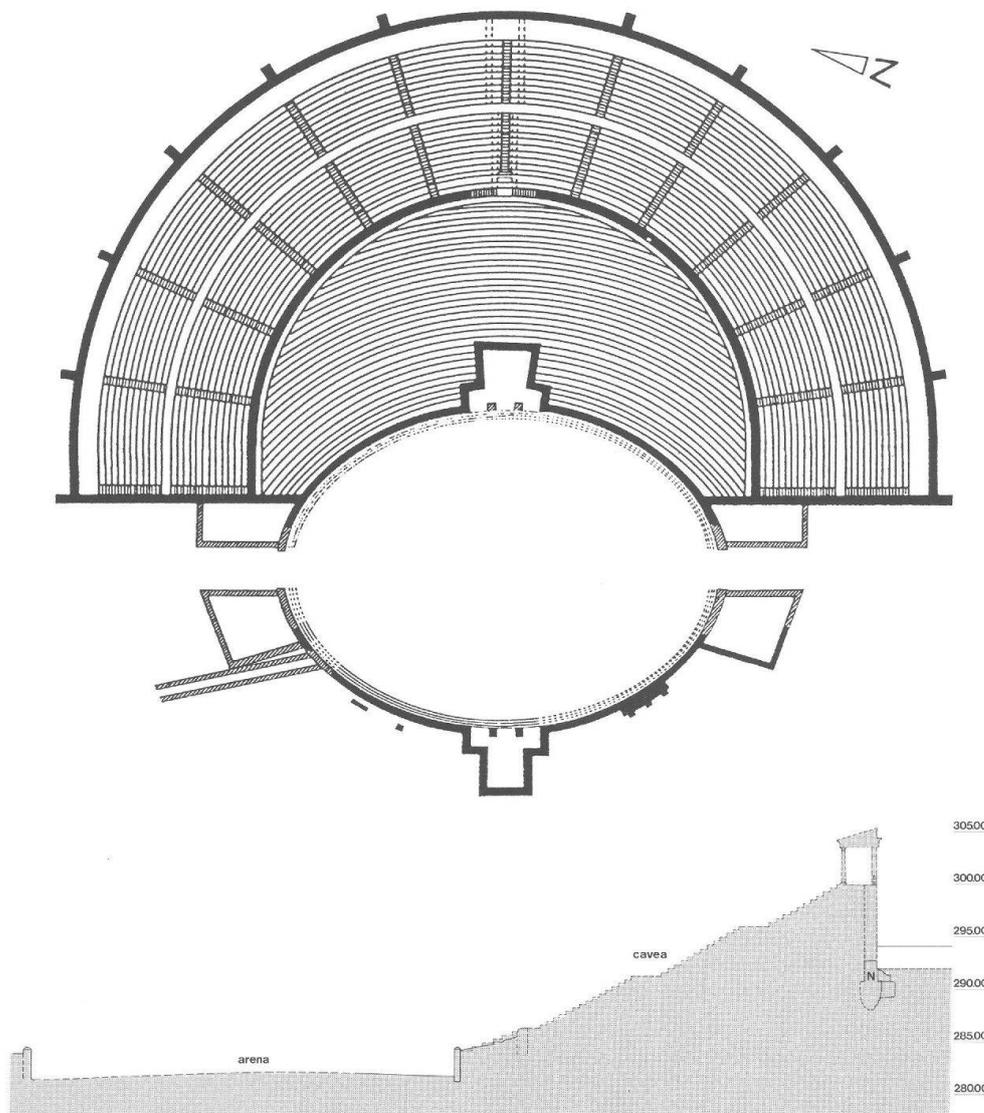
Abb. 5 Augst BL, Theater. Grundriss (oben) und Querschnitt (unten) des 2. Theaters (Arenatheater). M. 1:700.
