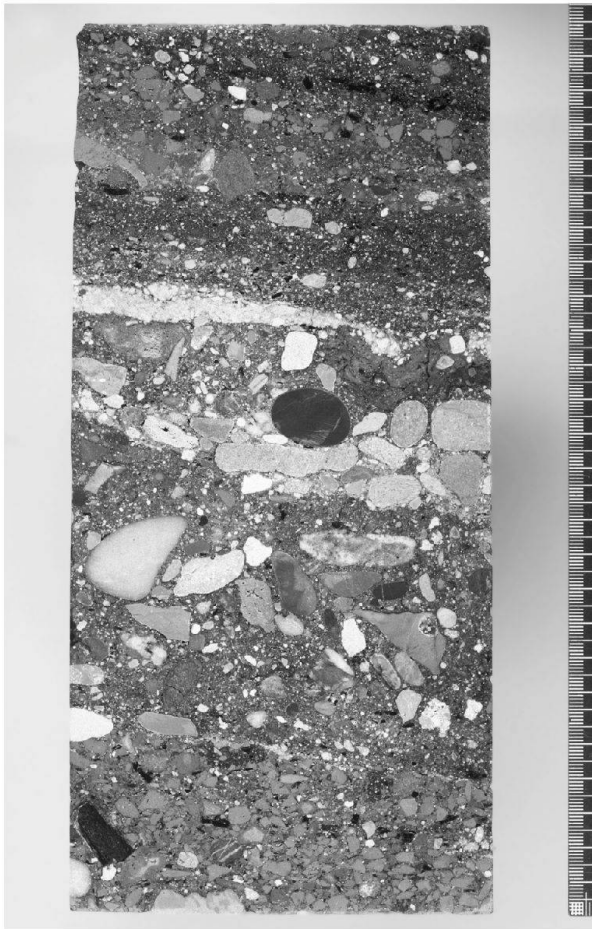
Abb. 9: Augst, Theatersanierung (Grabung 1994.055). Grundlagen zur Erarbeitung eines Auswertungskonzepts. In Kunstharz eingegossene und aufgesägte Bodenprobe zur sedimentologischen Weiterbearbeitung.
