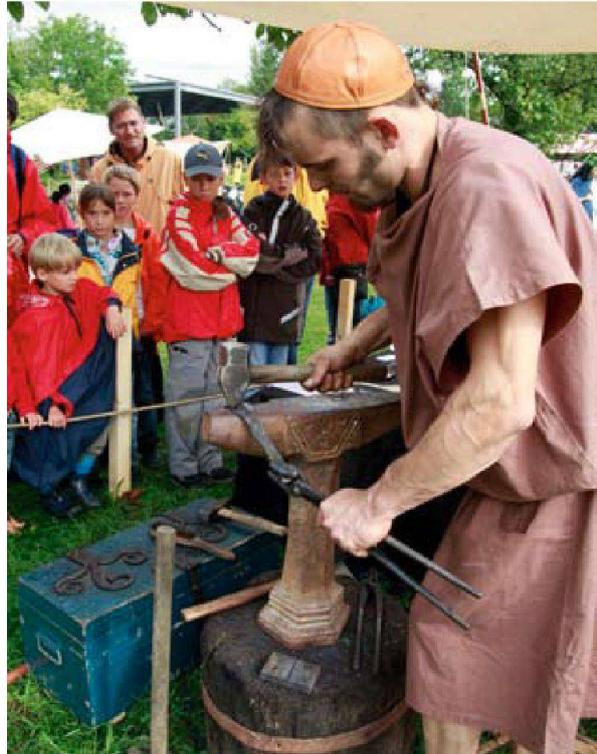
Abb. 27: Augusta Raurica, Römerfest 2010. Reto Zürcher als «römischer» Schmied bearbeitet einen Eisenstab, der – profiliert und feuerschweisst – als Verbindungsmuffe zwischen zwei Teucheln (hölzerne Wasserleitungsröhren) eingeschlagen werden soll.
