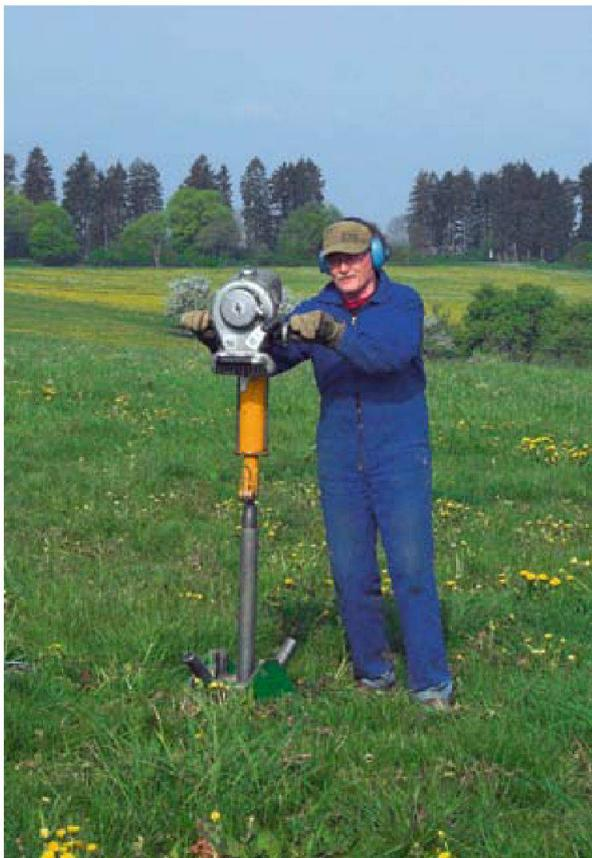
Abb. 5: Leichtes Kleinrammkern-Bohrgerät. Mit dem Einsatz eines solchen tragbaren Geräts entsteht kaum Flurschaden, wenn mitten in einem Acker eine Proben-Bohrung vorgenommen wird.
