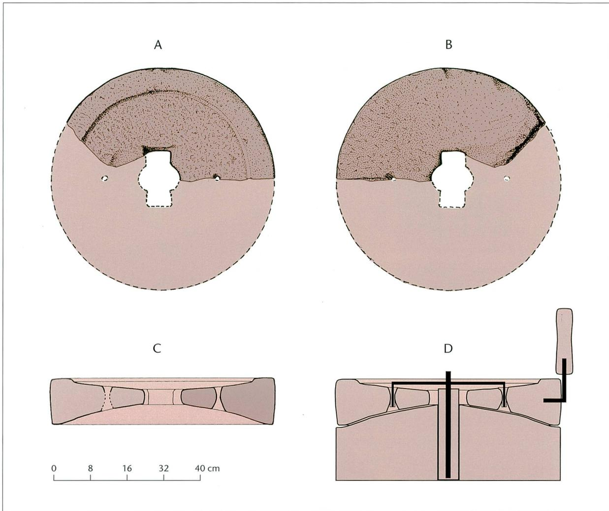
Abb. 15: Augst BL, Publikumsgrabung (Grabung 2015.058). Detailzeichnung des Mhlsteins (Inv. 2015.058.G00839.2) mit Schnitt und Rekonstruktion der gesamten Handmhle. M. 1:8.
