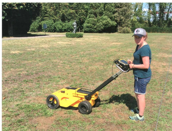
Abb. 7: Carmen Bucher (Fachhochschule Nordwestschweiz) beim Abschreiten der Messfläche auf Kastelen mit dem Bodenradarmessgerät.
