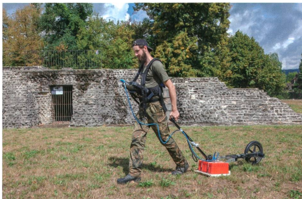
Abb. 5: Andreas Kreklau (Universität Bamberg) beim Abschreiten der Messfläche auf Schönbühl mit dem Bodenradarmessgerät.
