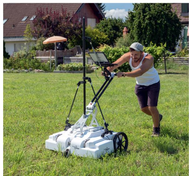
Abb. 7: Augst BL, Steinler (Vorgang 2019.059). Michal Vágner von der Universität Brno mit dem Georadargerät Raptor-45 (ImpulseRadar) bei den Messungen auf dem Steinler.
