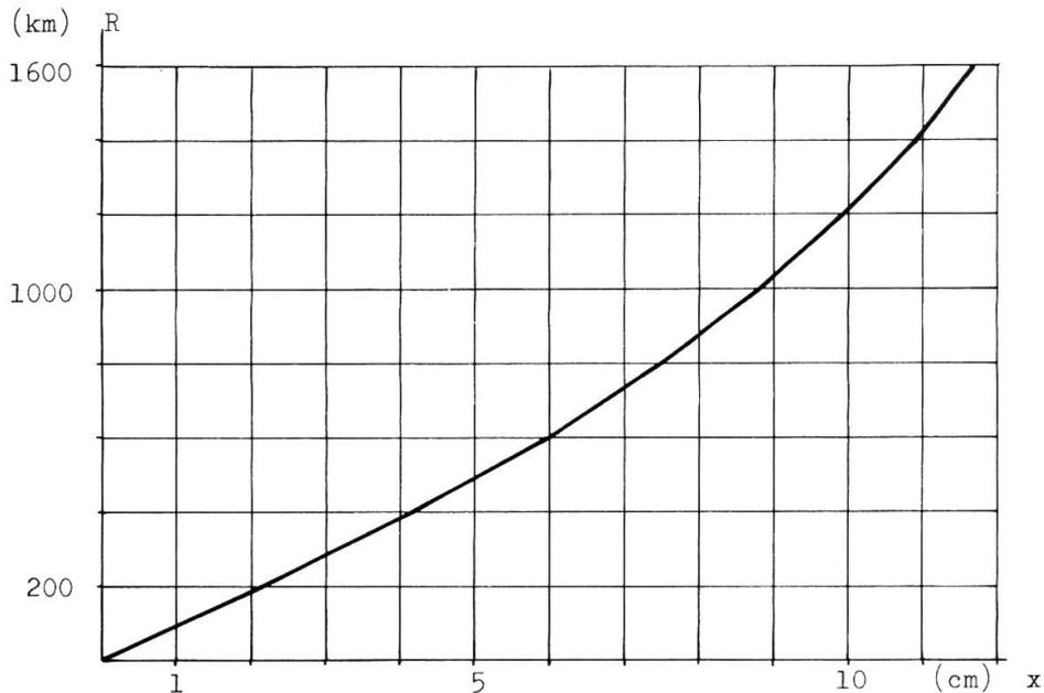
Fig.24: Beziehung zwischen der Orthogonal-Distanz  $x$  (in cm) eines Bildpunktes  $P$  von der Subsatellitenbahn und der entsprechenden Strecke  $R$  (in km) auf der Erdoberfläche (Gültig für das vergrößerte Bildmaterial der Sternwarte Bochum).
