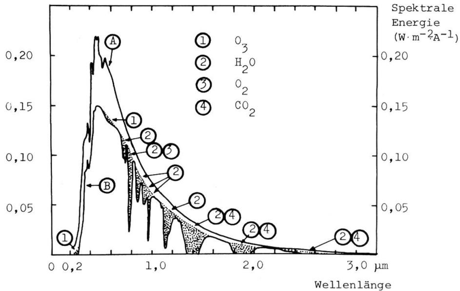
Fig.26: Spektrale Energieverteilung der von der Erde emittierten Strahlung auf Meereshöhe (A) und bei 27,5 mb (B), am 14.11.63, 20.00 Uhr, Rostov-on-Don. Spektrale Absorption durch Ozon, Wasserdampf und  $CO_2$ . (nach KONDRATYEV aus SCHENK, 1973:46).
