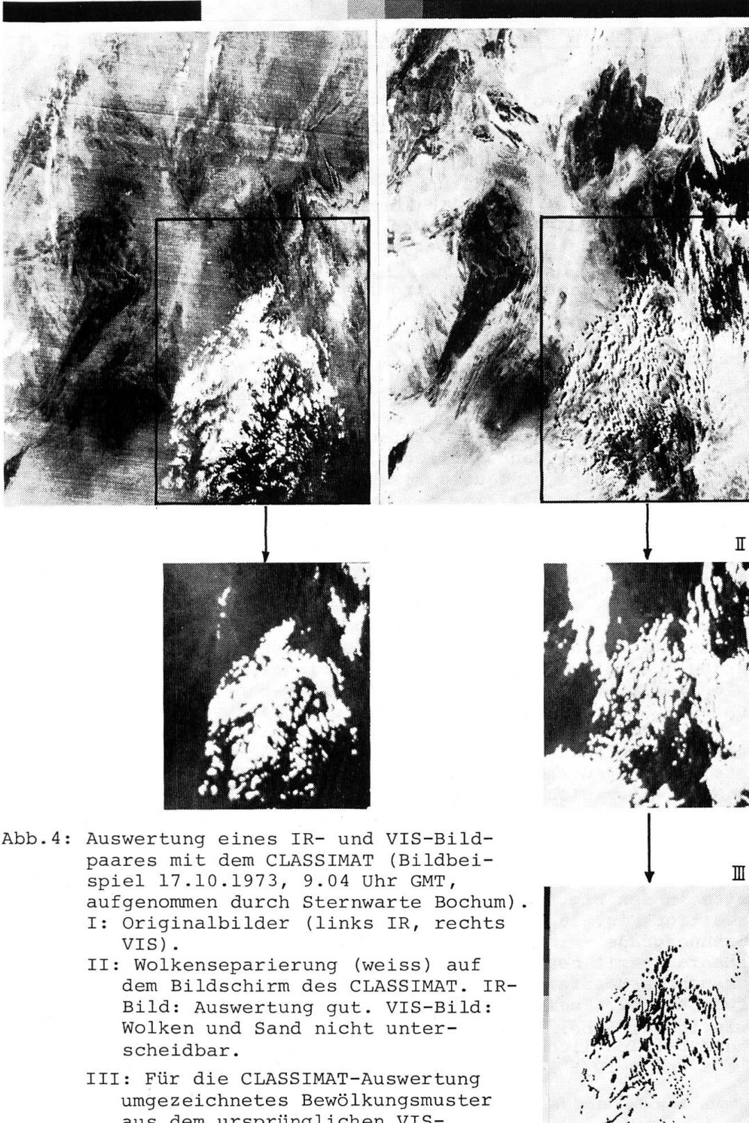
Abb.4: Auswertung eines IR- und VIS-Bildpaares mit dem CLASSIMAT (Bildbeispiel 17.10.1973, 9.04 Uhr GMT, aufgenommen durch Sternwarte Bochum).
