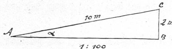
Das Dreieck A B C ist aus den beiden Seiten B C und A C und aus dem der grössern von diesen beiden Seiten gegenüberliegenden Winkel A B C konstruiert worden.
