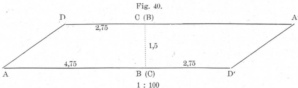
lang wie die beiden parallelen Trapezseiten, dessen Höhe gleich ihrem senkrechten Abstande ist, welcher auch Höhe des Trapezes heisst. Das Trapez A B C D ist die Hälfte dieses Parallelogramms, somit:
